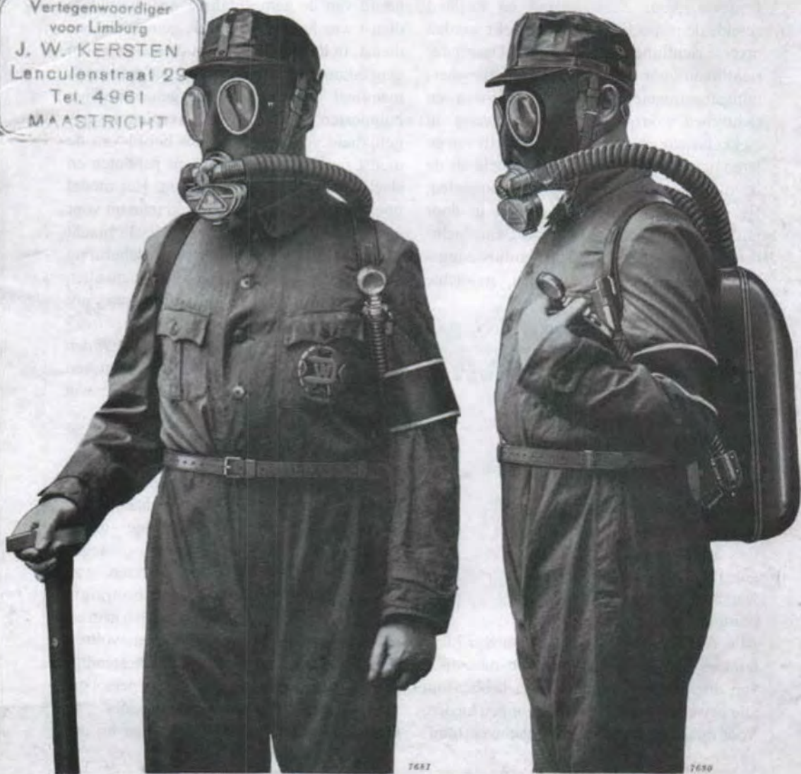
Gas Pleeg met Draeger-zuurstof-KG-apparaat, type 130, voor werktijd van 1 uur.
